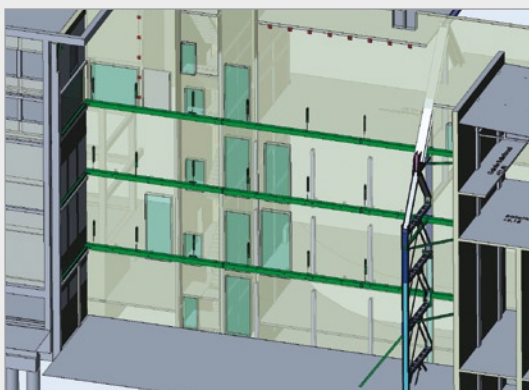
■ Sicherungsmaßnahmen am Werkstattgebäude
